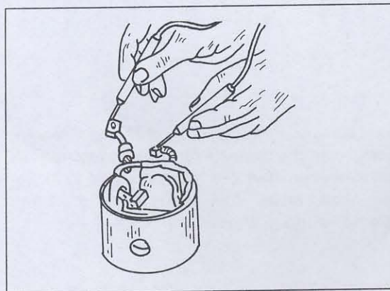
Bild 335 Überprüfung der beiden Anlasserbürsten auf Stromdurchlass. Falls kein Strom durchfließt, ist der Stromkreis unterbrochen.
